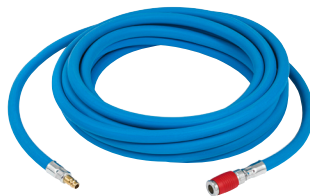
Korkealaatuinen ilmaletku maaliruiskuihin Sisäläpimitta 9 mm, pituus 10 m, pikaliitin ja nip- pa, antistaattinen, ei sisällä maalausta haittaavia aineita, paineenkestävä 20 bar, erittäin käyttö- varma. Tuotenro 53090
